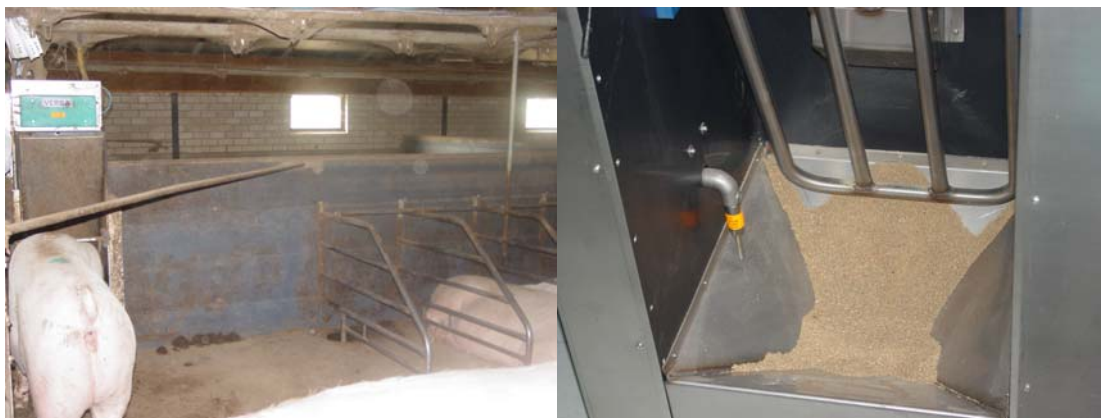
Figuur 18 Vario-Mix met dierherkenning (rechts detail voederbak met terugslagklep)
